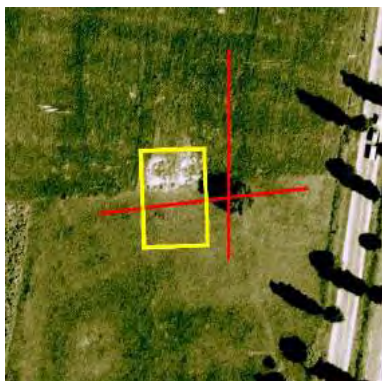
Sárga téglalap a radarozás, a két piros vonal az elektromos fajlagos ellenállás mérés helye.
