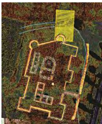
Sárga téglalap a radarozás, a két piros vonal az elektromos fajlagos ellenállás mérés helye.
